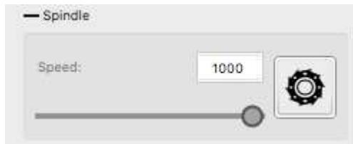
Cette partie permet de régler manuellement la vitesse de rotation de la broche. Un bouton permet de stopper ou relancer la rotation. Pratique pour nettoyer la fraise après avoir mis la gravure en pause.
